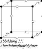
Abbildung 27: Aluminiumfluoridgitter (Elementarzelle)
